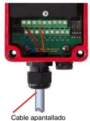
Pantalla aislada: Ninguna conectada a tierra ni a carcasa del detector
